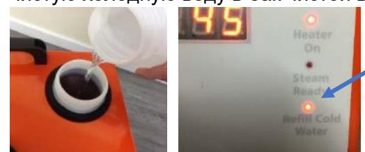
Машина будет подавать звуковой сигнал, а подача пара из сопла при нажатии переключателя на рукоятке прекращается. Если бак чистой воды пуст, насосы не работают.
